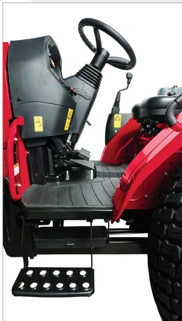
LE MARCHEPIED DE L'OPÉRATEUR FACILITE LA MONTÉE ET LA DESCENTE DU TRACTEUR.
