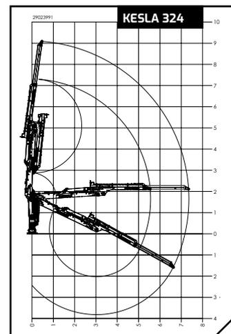
\* Capacité de levage sans grappin et sans rotator. La capacité de levage dépend de la hauteur et de la portée des bras.
